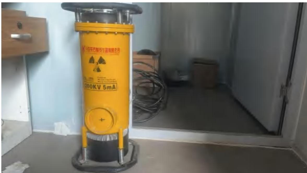
图 2-3 本项目 X 射线探伤机
